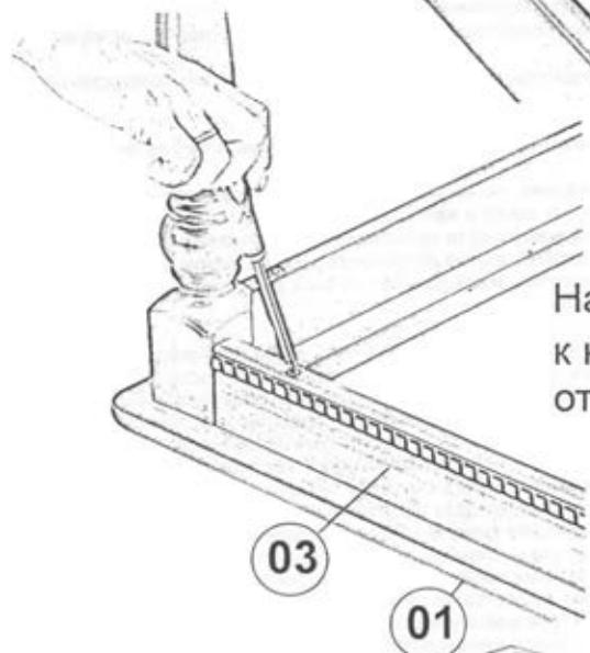
На саморезы крепить царги 03 к крышке стола 01 при помощи отвертки.
