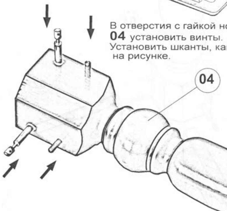
В отверстия с гайкой ножки стола **04** установить винты.
