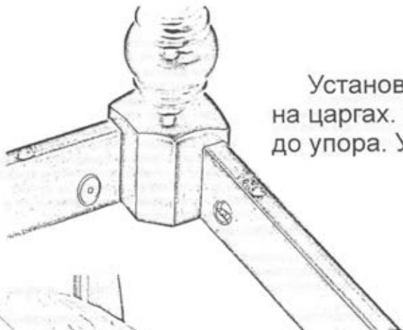
Установить сегмент в отверстия на царгах. Зафиксировать винт до упора. Установить заглушку.
